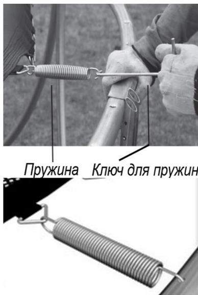
1. Зацепите пружину (более загнутым концом) за треугольное кольцо, закреплённое на полотне. Используя инструмент для пружин, захватите противоположный конец пружины.
